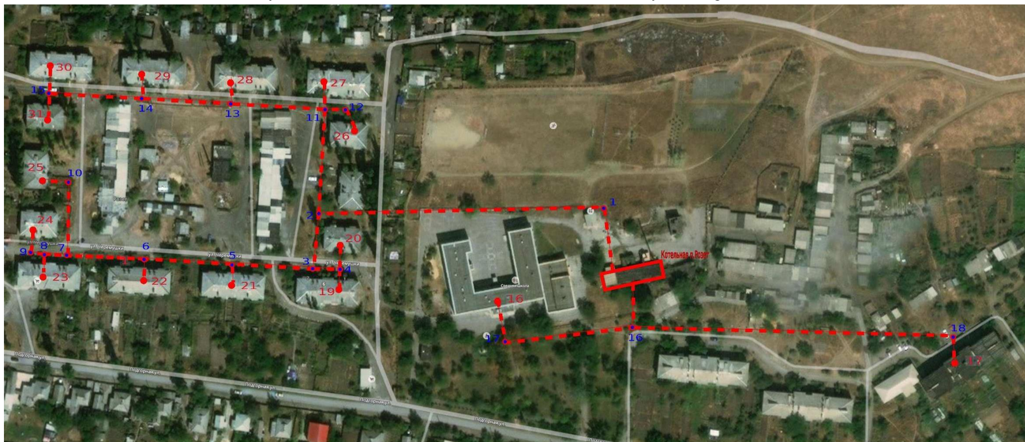
Рисунок 1.3.2.б - Схема тепловой сети котельной пос. Розет ул. Подгорная 12а
